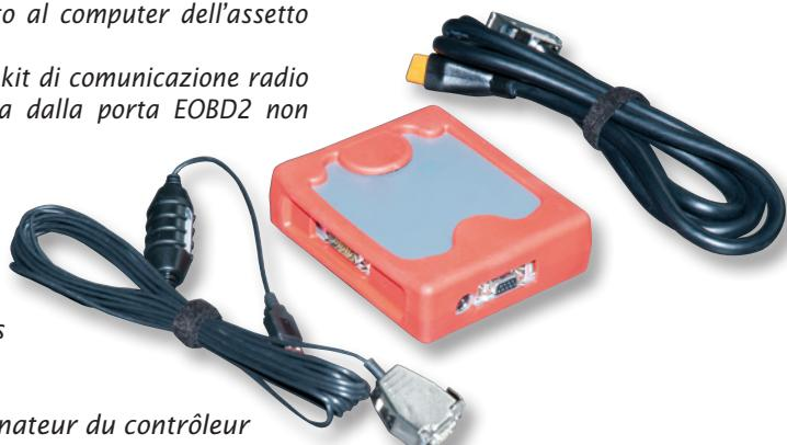
**FR** Sur la version base du Cal One-Touch la connexion à l'ordinateur du contrôleur de la géométrie s'effectue à travers le câble USB.
