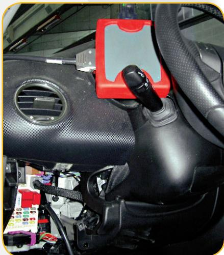
**IT** Modulo di comunicazione con le centraline elettroniche della vettura.
